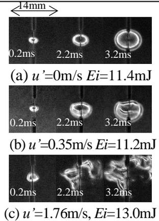
Fig.5 Schlieren images in turbulence ( $\phi=0.8$ ,  $\delta_H=0.5$ ,  $S_{L0}=25$ cm/s)
