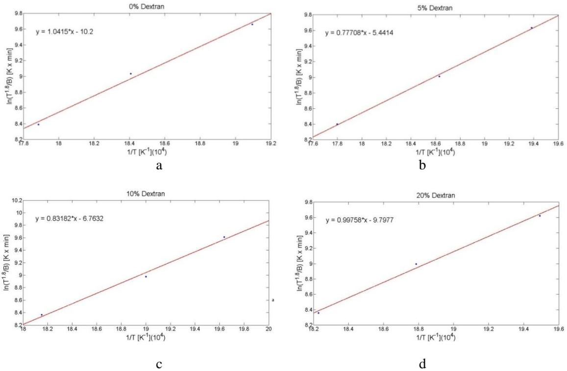
**Figure 7**– Arrhenius plots for the exothermic peaks in the system  $\text{NH}_4\text{NO}_3/\text{Dextran}$ : (a)  $\text{NH}_4\text{NO}_3$  decomposition, (b)  $\text{NH}_4\text{NO}_3$ -5 wt.% Dextran, (c)  $\text{NH}_4\text{NO}_3$ -10 wt.% Dextran, (d)  $\text{NH}_4\text{NO}_3$ -20 wt.% Dextran
