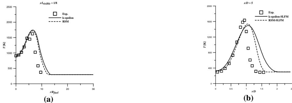
Figure 1 : Effect of turbulence modelling in : (a) :  $\text{H}_2$  / Air flame, (b) :  $(\text{CH}_4\text{-H}_2\text{-N}_2)$  / Air flame
