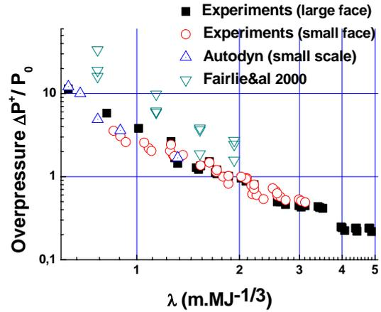
(d) Reflected overpressure,  $\theta = 45^\circ$
