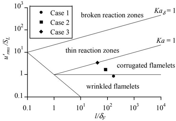
Fig. 1 Turbulent combustion diagram<sup>[1]</sup>
